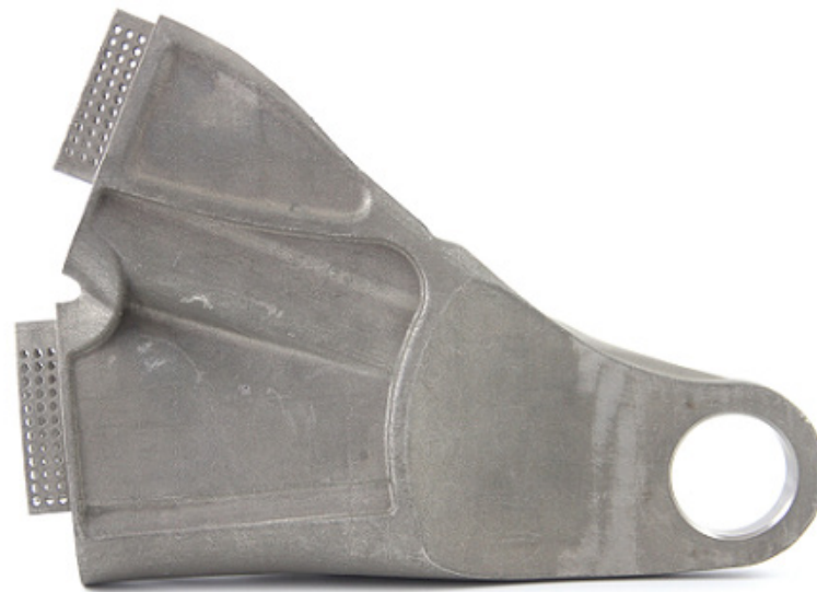
Rys. 3. Wahacz poprzeczny wykonany technologią druku 3D z tytanu (zdj. Gerlach Delissen oraz InMotion Automotive, https://3dprint.com )
