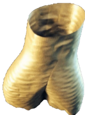
Rys. 4. Kolektor wykonany technologią druku 3D ze stopu Ni718 z efektem wybożenia przez zbyt cienkie ściany (zdj. Renishaw, https://www.epma.com )
