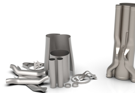
Rys. 1. Po lewej – 20 części blaszanych i hydroformowanych potrzebnych do montażu oryginalnej rury wydechowej. Po prawej – pojedyncza, monolityczna rura wydechowa, wykonana w technologii druku 3D przez firmę 3D Systems. (zdj. https://www.3dsystems.com/ )
